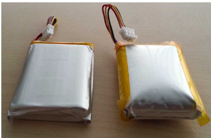
Eine Lithium-Polymer-Zelle (links im Normalzustand) kann durch Lagerung bei falscher Temperatur und dadurch entstandenem inneren Druckaufbau „gebläht“ werden (rechts) (Foto: BE-Power GmbH)
